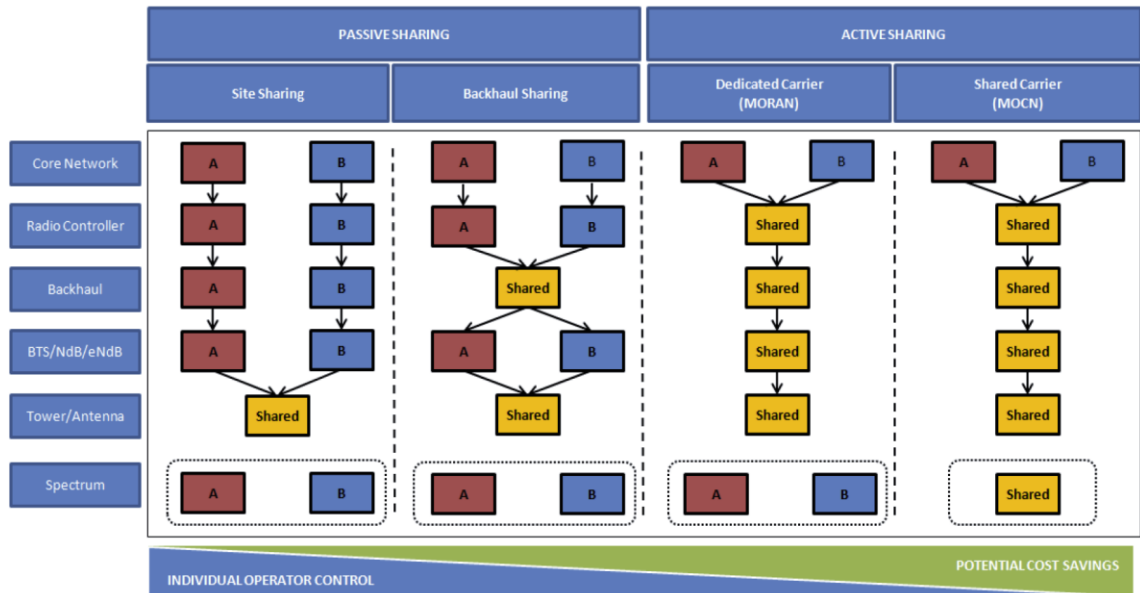
Figuur 20: Verschillende standaarden voor netwerk sharing: (bron: ITU-T / NSN Networks /TMG 48 Niet gedefinieerd door 3GPP maar wordt in de praktijk wel toegepast: MORAN: Multiple Operator Radio Access Network, Gedefinieerd door 3GPP: MOCN = Multi Operator Core Network (bron: ITU-T / NSN Networks /TMGMulti-operator and neutral host small cells, Small Cell Forum)
